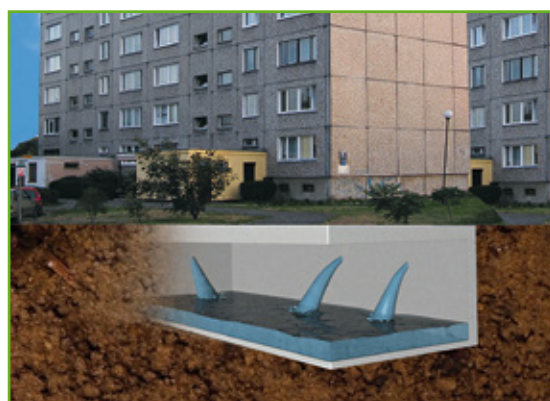
Suterény často nie sú prístupné z vonkajšej strany. Preto môžu byť izolované jedine z vnútornej strany (negatívna strana).
