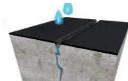
Elastické, ale nepremostujúce trhliny: nevydržia trvalý tlak vody.
