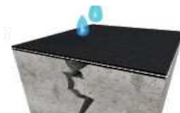
Hydroizolácia premostujúca trhliny výstužnou tkaninou: výstužná tkanina oddeľuje vrchnú hydroizolačnú vrstvu od trhliny a výrazne pomáha odolávať trvalému tlaku vody.
