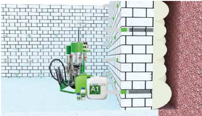
Murivo: clonová injektáž.
